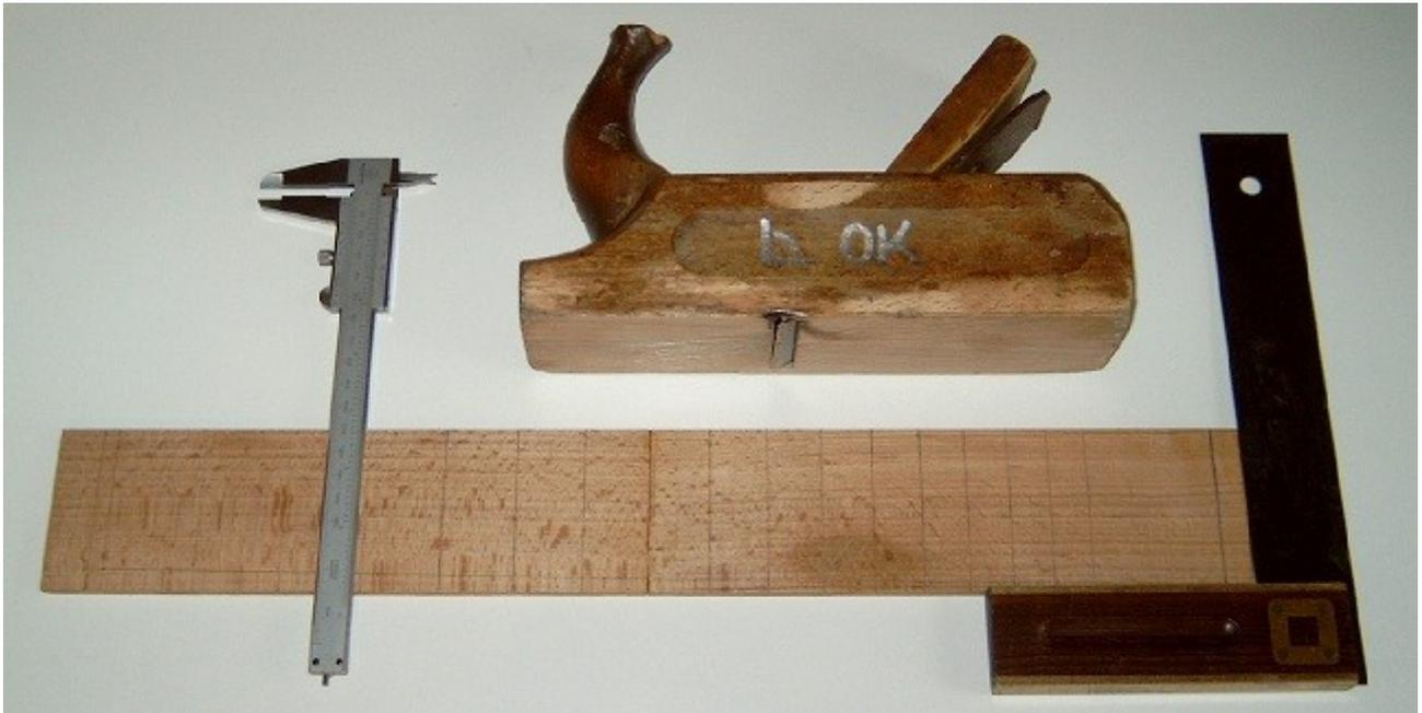
Die beiden Brettchen sind mit Epoxydharz Endfest verbunden und verweilten zum aushärten bei 100° C für 10 Minuten im Backofen. Die Klebestelle kann man im Bild gut erkennen. Die Bundschlitze werde ich nach der Schablone von Stew Mac
